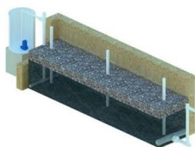
研究人员在西弗吉尼亚的一个循环水产养殖系统中建立了一个长形的充满木屑的生物反应器来处理废水，鱼缸里的水在生物反应器的一端进入，流经木片，然后通过另一端的管道出来，在此过程中，经过固体沉降，木屑中的细菌去除氮。这项研究利用一个鱼缸展示了如何有效地去除中西部的农田排水中的过剩氮。研究团队建立四个相同的生物反应器，设置不同的停留时间(水在反应器中的流经时间)不同，从12小时到55小时不等。结果发现，既能处理水，又避免堵塞的最佳的保留时间是24小时。
